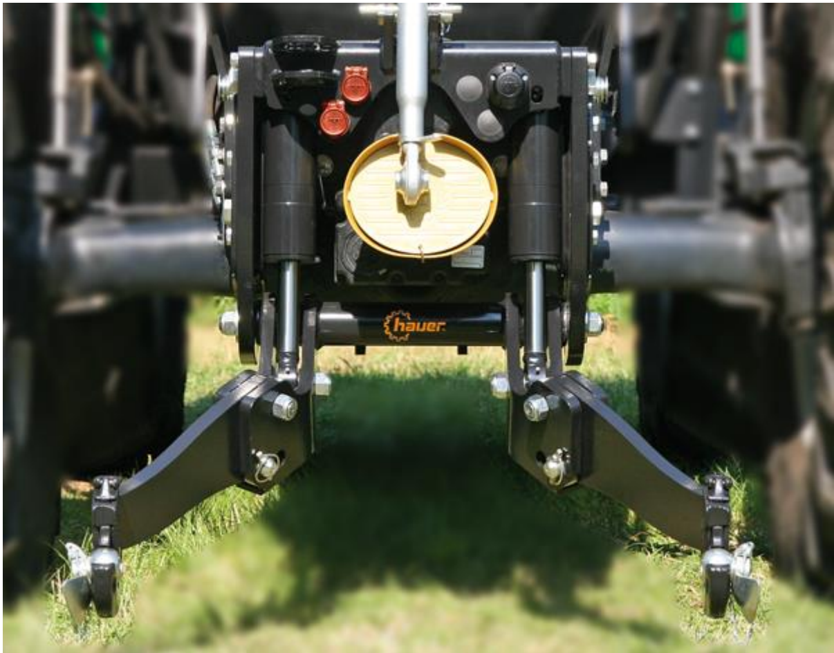
Prednji kardanski pogon s prednjo dvižno hidravlike FS-4
